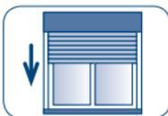
Wird die Auf oder Ab Taste gedrückt und losgelassen, fährt der Motor in die gewünschte Richtung bis die jeweilige Endposition erreicht wird.
