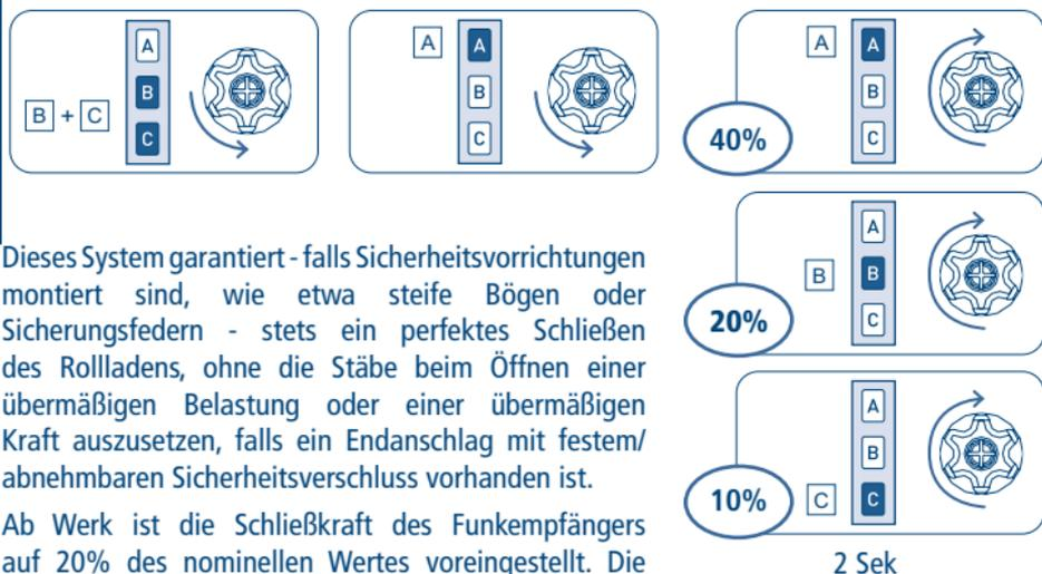
Dieses System garantiert - falls Sicherheitsvorrichtungen montiert sind, wie etwa steife Bögen oder Sicherungsfedern - stets ein perfektes Schließen des Rollladens, ohne die Stäbe beim Öffnen einer übermäßigen Belastung oder einer übermäßigen Kraft auszusetzen, falls ein Endanschlag mit festem/ abnehmbarem Sicherheitsverschluss vorhanden ist.
