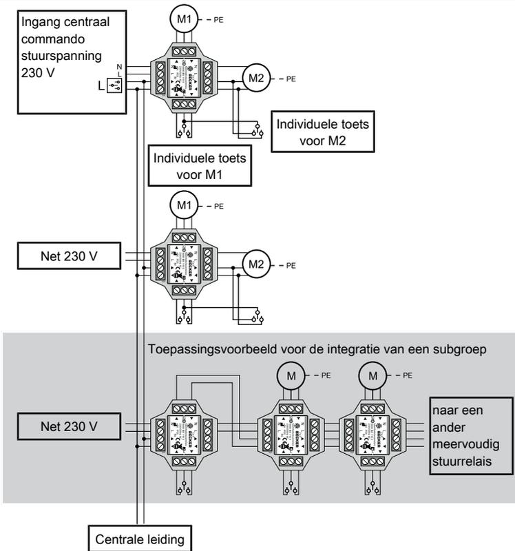
**i** Voor elke subgroep is een aanvullend meervoudig stuurrelais vereist. In dit toepassingsvoorbeeld wordt in de subgroep per meervoudig stuurrelais een aandrijving bestuurd. Als alternatief kunnen via een meervoudig stuurrelais, zoals hierboven weergegeven, ook 2 aandrijvingen worden gebruikt.
