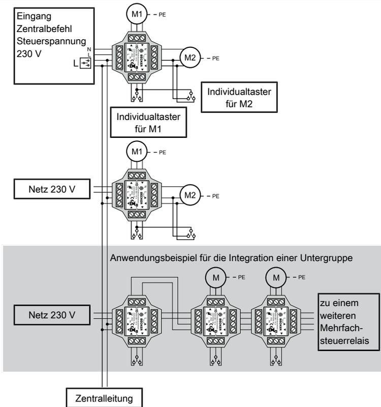
**i** Für jede Untergruppe wird ein zusätzliches Mehrfachsteuerrelais benötigt. In diesem Anwendungsbeispiel wird in der Untergruppe pro Mehrfachsteuerrelais ein Antrieb gesteuert. Alternativ können an einem Mehrfachsteuerrelais, wie obenstehend gezeigt, auch 2 Antriebe betrieben werden.
