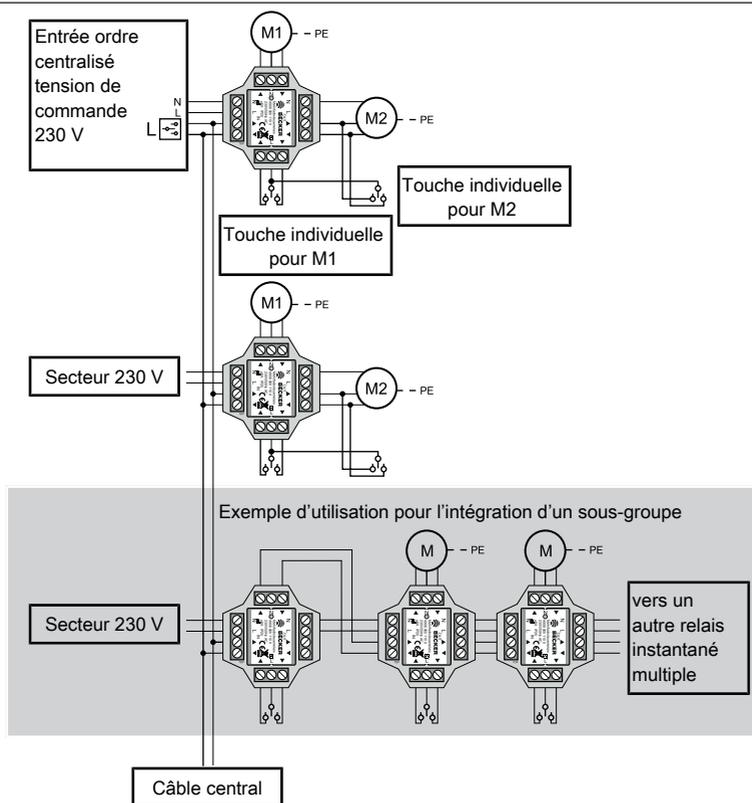
**i** Un relais instantané multiple supplémentaire est nécessaire pour chaque sous-groupe. Dans cet exemple d'utilisation, un relais instantané multiple commande un moteur dans le sous-groupe. Un relais instantané multiple peut également commander 2 moteurs, comme indiqué ci-dessus.
